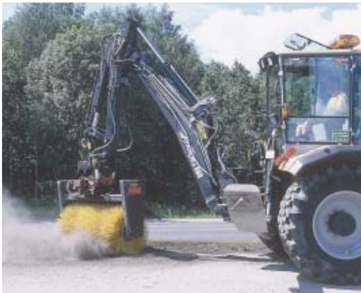
Sopaggregat kan med fördel monteras på en Huddig 860.
